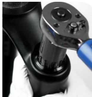
Abdeckkappen-/ Kassettenwerkzeug 28 N·m
