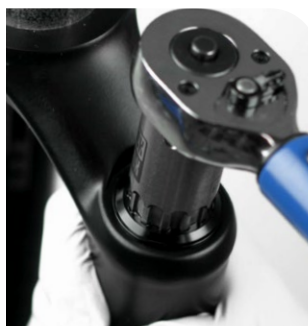
Herramienta para casete/tapa superior 28 N·m
