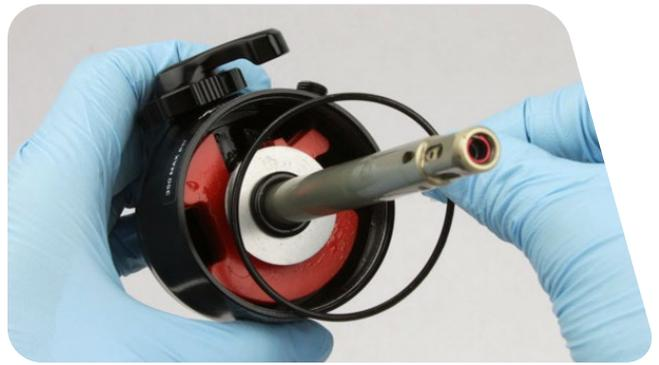
**15** Instale el conjunto cabeza/pistón en el eje del amortiguador.
