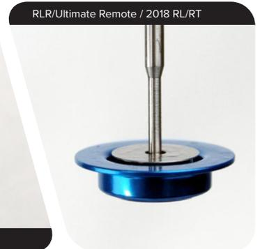
Aplique un poco de grasa a la punta del vástago de compresión. Instale el vástago de compresión y el sombrerete en el conjunto del pistón principal.
