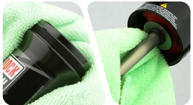
**2** Utilice un punzón para retirar la junta guardapolvo del manguito del amortiguador que se encuentra en la ranura superior.
