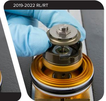
**RLR/Ultimate Remote / 2018 RL/RT:** Instale el muelle del sombrerete superior y su respectiva arandela sobre el vástago de compresión. Sujete el vástago de compresión en posición vertical de modo que el muelle quede asentado en la ranura que hay dentro del sombrerete.
