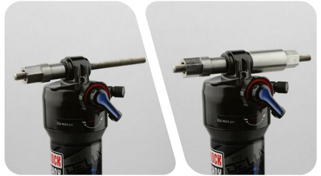
**3** Sujete con el tornillo de banco la pieza receptora o agárrela con firmeza con una llave inglesa fija o ajustable de 13 mm.
