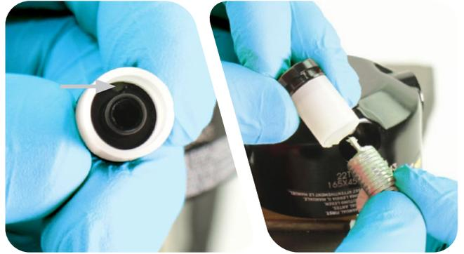
El rabillo del muelle debe ser visible a través del precargador si se instala correctamente.
