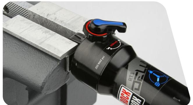
**4** Retire el indicador de prehundimiento ("sag").
