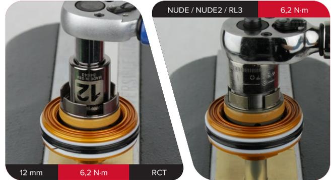
**RT3; 2019-2022 RL/RT:** Utilice una llave dinamométrica con vaso de 12 mm para apretar la tuerca con un par de 4,5 N·m.
