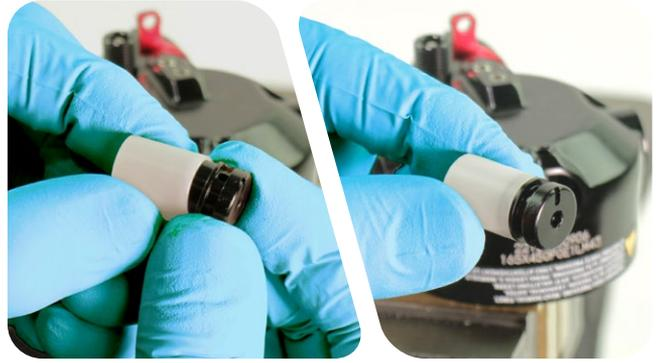
5 Instale el muelle en el casquillo e introduzca el rabillo del muelle en el orificio del precargador.
