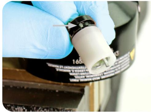
Instale el precargador, el casquillo y el muelle en el ojal e introduzca el rabillo del muelle en el orificio correspondiente del ojal.
