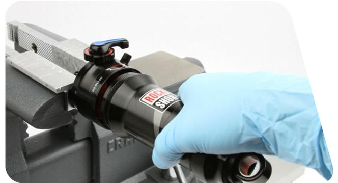
**5** Suelte el amortiguador del tornillo de banco. Déle la vuelta y sujete por el ojal el cuerpo del amortiguador con el tornillo de banco.
