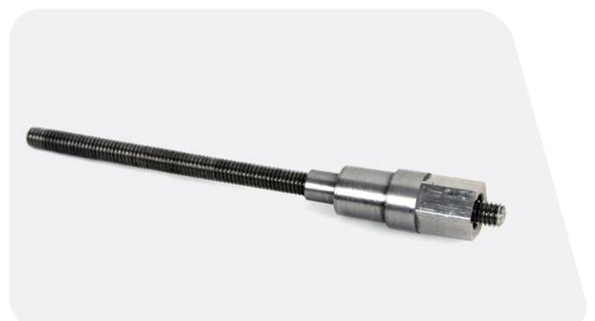
**2** Inserte el vástago roscado a través del ojal del eje hasta que el empujador quede apoyado contra el pasador del cojinete.
