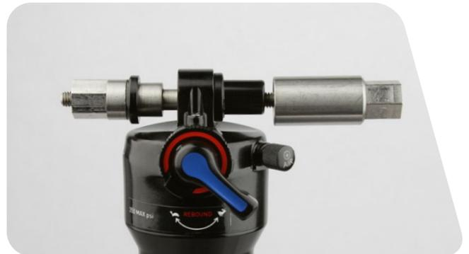
**4** Si no consigue sacar fácilmente el pasador del cojinete, vuelva a insertar el vástago roscado y el empujador a través del ojal del eje.
