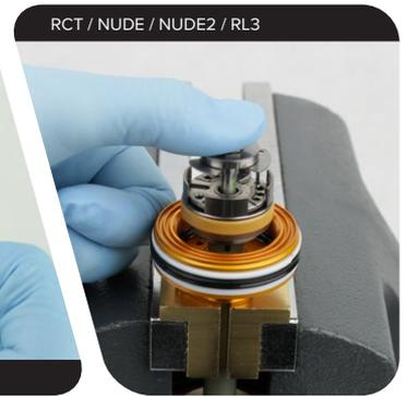
**2019-2022 RL/RT:** Aplique un poco de grasa a la punta del vástago de compresión. Instale el vástago de compresión y el sombrerete en el conjunto del pistón principal.
