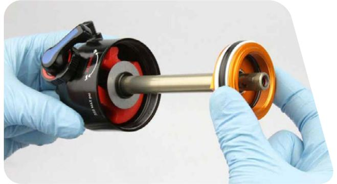
**16** Utilice un bloque adaptador para tornillo de banco con la mordaza para eje de 10 mm para sujetar el eje a un tornillo de banco.
