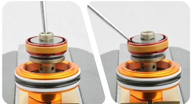
**18** Rocíe con alcohol isopropílico la rosca de la tuerca del pistón y límpiela con un trapo.
