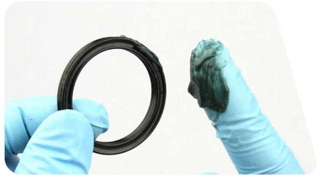
**1** Utilice los dedos para retirar la junta tórica del exterior del manguito del amortiguador.
