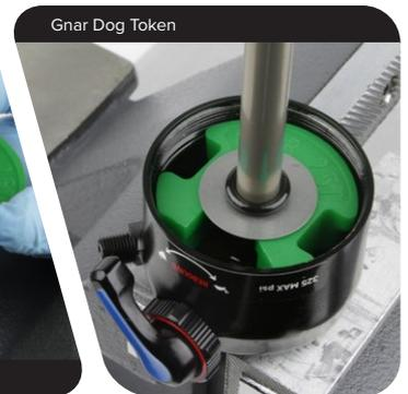
**Extracción de elementos:** Sujete el ojal del eje en el tornillo de banco.
