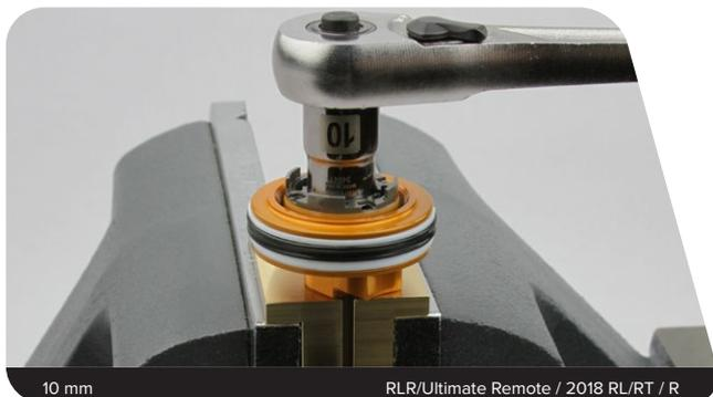
**8** Utilice una llave inglesa pequeña o un punzón para deslizar el conjunto del pistón principal hasta que se desprenda del eje y sea recogido por la herramienta.
