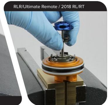
**4** **RLR/Ultimate Remote / RL/RT:** Entfernen Sie die O-Ringe der Druckstange mit einem Dorn.
