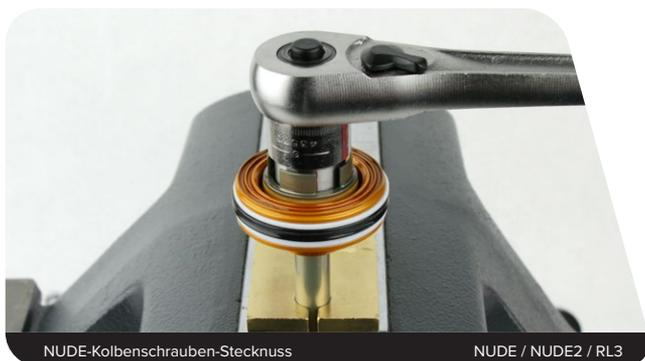
**RLR/Ultimate Remote / 2018 RL/RT / R:** Entfernen Sie die Kolbenmutter mit einer 10-mm-Steckschlüssel.
