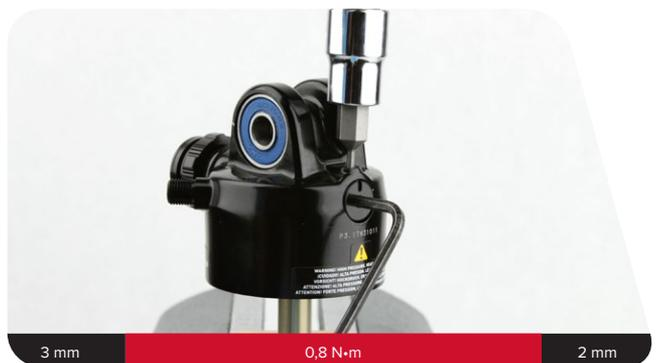
Die Fernbedienungsfeder kann gewartet werden, ohne eine komplette Wartung von Luftkammer und Dämpfer durchzuführen.
