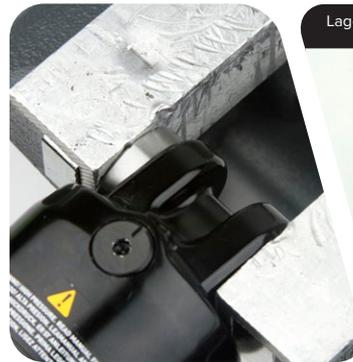
Lagereinpresswerkzeug mit 22 mm Außen- und 10 mm Innendurchmesser
