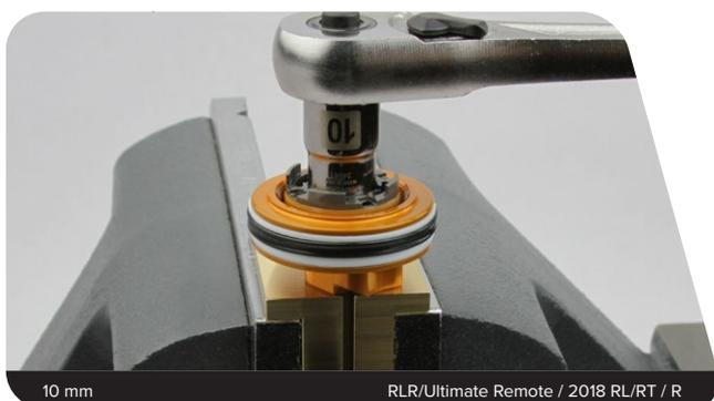
**8** Schieben Sie mit einem kleinen Schraubenschlüssel oder Dorn die Hauptkolben-Baugruppe von der Führungsstange auf das Werkzeug.
