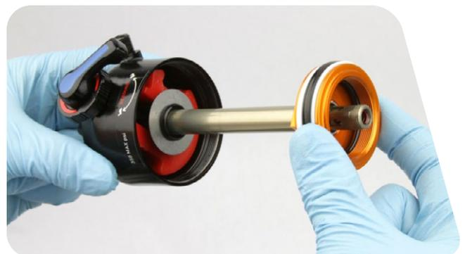
**10** Entfernen Sie die Anschlagpuffer O-Ring von der Dämpferführungsstange.
