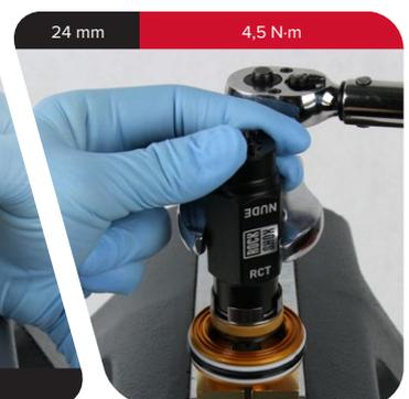
**20 RCT / NUDE / NUDE2 / SCOTT RL3:** Tragen Sie ein wenig Fett auf die Mitte der Druckstange und unterhalb der oberen Verschlusskappe auf der Druckstange auf. Drücken Sie die Mutter der oberen Verschlusskappen-Baugruppe nach unten, um die Druckstange und die obere Verschlusskappe in der Hauptkolben-Baugruppe zu installieren, und richten Sie dann den Führungsstift in der Kolben-Baugruppe auf die Führungsstiftbohrung in der oberen Verschlusskappen-Baugruppe aus.
