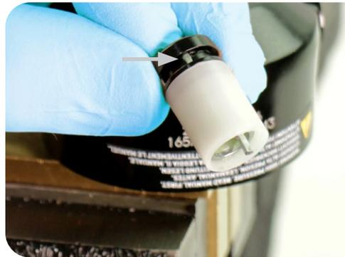
Führen Sie den Vorspanner, die Buchse und die Feder in das Auge ein und setzen Sie den Federzapfen in die Federzapfenöffnung im Auge ein.
