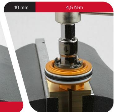
**19 RCT / NUDE / NUDE2 / SCOTT RL3:** Montieren Sie die Distanzscheiben, die Sicherungsscheibe(n) und den Verschlusskolben in dieser Reihenfolge auf der Kolben-Baugruppe. Stellen Sie sicher, dass jedes der Teile mittig auf der Kolbenschraube sitzt.
