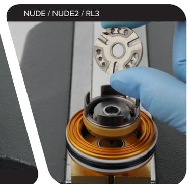
Richten Sie den Führungsstift am Kolben auf die Führungsbohrung im RCT / NUDE-Verschlusskolbenwerkzeug aus. Beginnen Sie von Hand, den Verschlusskolben aufzuschrauben, und setzen Sie dann einen 24-mm-Maulschlüssel an das RCT / NUDE-Verschlusskolbenwerkzeug an, um den Verschlusskolben mit 4,5 N·m festzuziehen.
