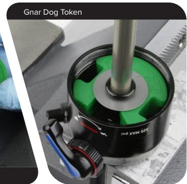
**Ausbau von Tokens:** Spannen Sie das Führungsstangenauge in den Schraubstock ein.
