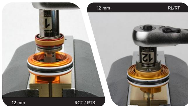
**NUDE / NUDE2 / SCOTT RL3:** Lösen Sie die Kolbenschraube mit einer NUDE-Kolbenschrauben-Stecknuss.
