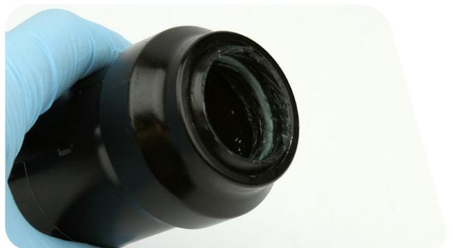
**10** Nur NUDE2 / SCOTT RL3: Spannen Sie das Führungsstangenauge senkrecht in den Schraubstock ein.
