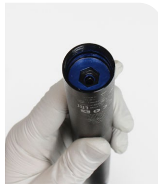
Eje neumático desenroscado del cabezal de la tija de sillín
