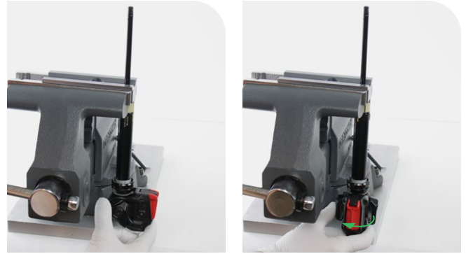
Pistón neumático desenroscado del eje neumático
