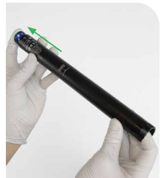
Eje neumático desenroscado del cabezal de la tija de sillín
