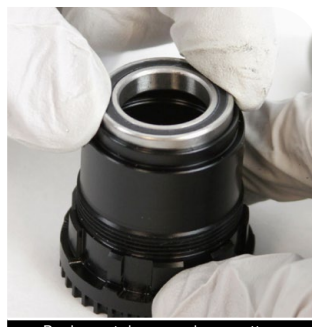
Roulement de corps de cassette 6803/61803
