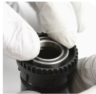
Roulement de corps de cassette 6803/61803
