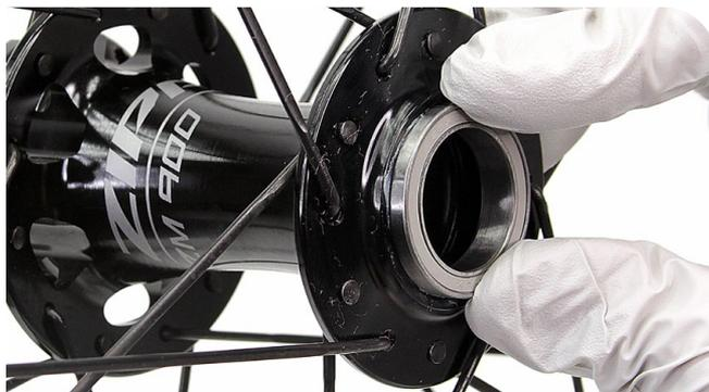
**5** Faites coulisser une presse à roulement Zipp 23x32x7 sur la tige filetée de la presse à roulement.
