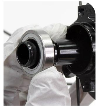
**7** Nettoyez l'axe avec un chiffon et de l'alcool isopropylique.
