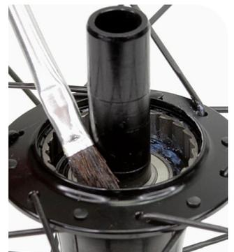
**8** Installez le corps de cassette sur l'axe et faites-le tourner dans le sens inverse des aiguilles d'une montre afin de mettre en place le corps de cassette avec son joint.
