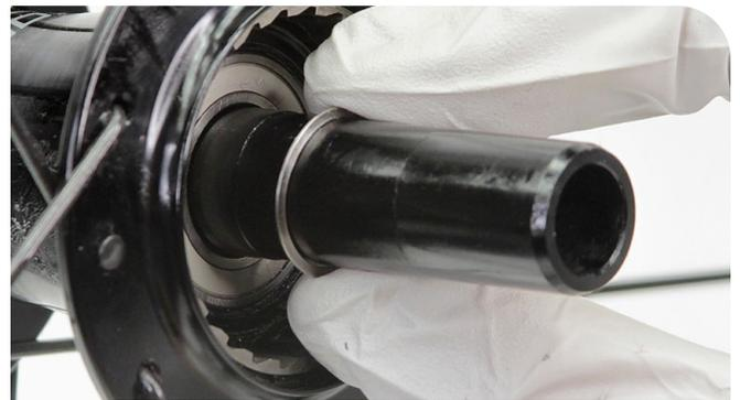
**7** À l'aide d'une seringue pour graisse SRAM Butter, déposez 1 gramme de graisse sur le mécanisme à rochets.
