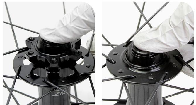
**8** Nettoyez le moyeu avec un chiffon et de l'alcool isopropylique.
