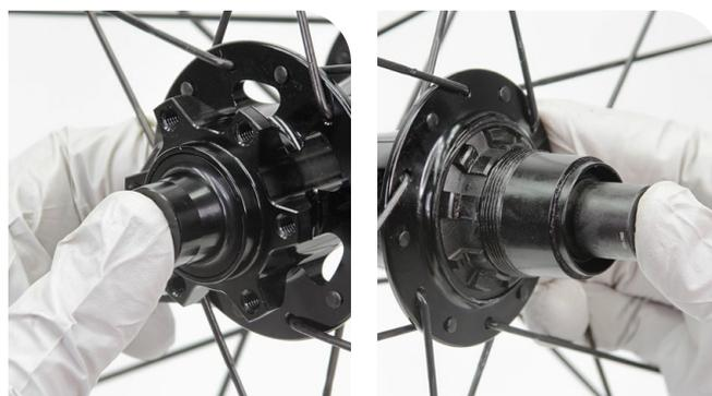
**11** Nettoyez le moyeu avec un chiffon et de l'alcool isopropylique.
