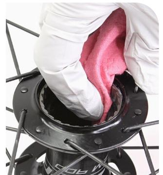
**9** Nettoyez le mécanisme à rochets et les parties internes du moyeu avec de l'alcool isopropylique, un chiffon et des cotons-tiges. Ne retirez pas le mécanisme à rochets.
