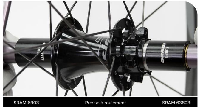
**6** Installez la rondelle sur l'axe du côté de la chaîne.
