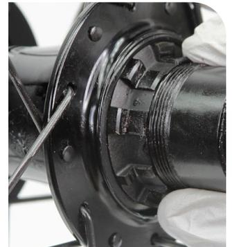
**9** Appliquez de la graisse aux endroits indiqués ci-dessous sur les deux extrémités de l'axe, du côté de la chaîne et du côté opposé à la chaîne :
