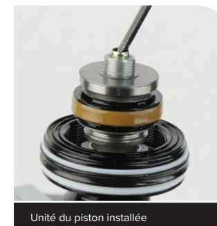
Unité du piston installée
