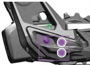
Como alternativa, pulse el botón AXS del desviador dos veces rápidamente para moverlo hacia dentro una posición cada vez, hasta que quede en la posición del piñón de ajuste.
