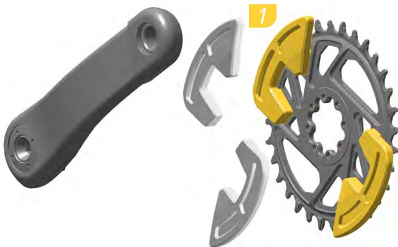
1. Coloque el protector en la parte delantera del aro, entre el brazo de biela y el plato, introduciéndolo en la abertura del plato.
