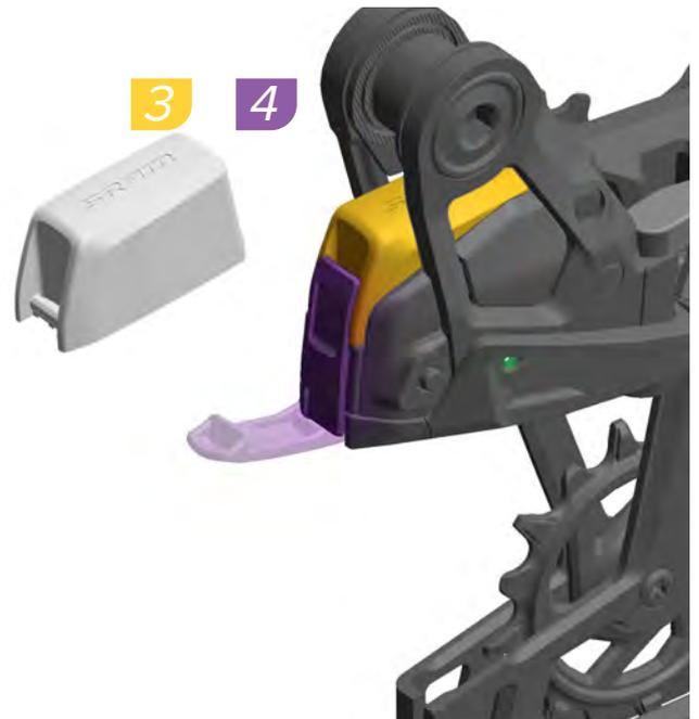
3. Inserte la batería SRAM completamente cargada en el desviador.
