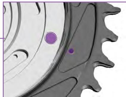
2. Coloque el plato nuevo en el lado interior de la araña del medidor de potencia de forma que los puntos blancos de la araña y el plato queden alineados.
