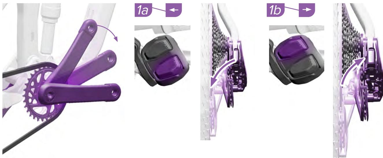
1a. Gire las bielas lentamente y pulse el botón inferior del controlador pod AXS para desplazar el desviador completamente hacia dentro.
