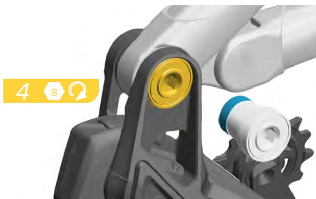
4. Instale y apriete el perno del soporte en sentido horario hasta que quede ajustado.
