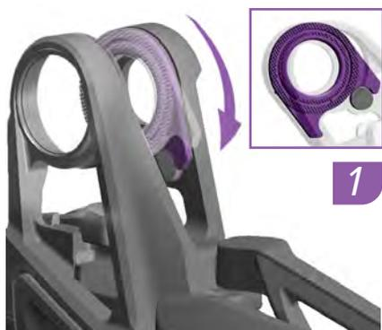
1. Gire el anillo moleteado en sentido horario hasta alcanzar el tope del anillo. Asegúrese de que el tope del anillo queda entre los salientes del anillo moleteado.
