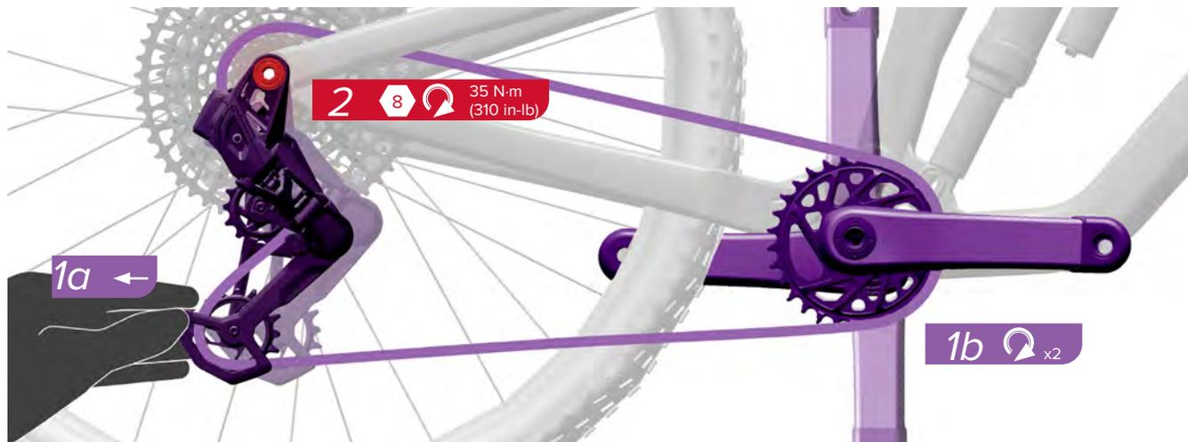
1a. Tire hacia atrás de la jaula inferior del desviador de la Transmission para eliminar la holgura de la cadena.
