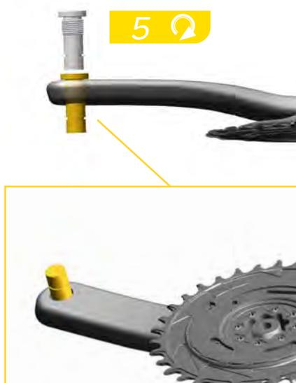
5. Enrosque a mano el espárrago en el orificio del pedal del brazo de biela.
