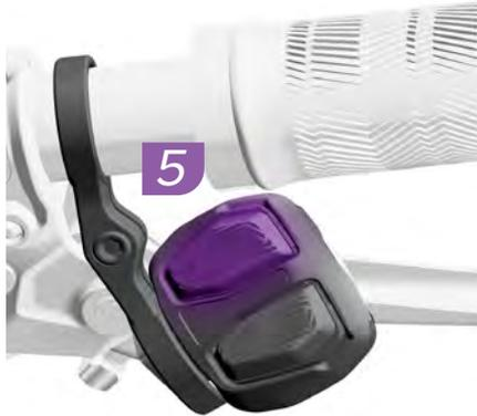
5. Pulse el botón superior del controlador para desplazar el desviador completamente hacia fuera.
