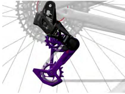
**Modo de configuración:** La jaula del desviador se extiende ligeramente para alinearse con cualquiera de las dos líneas clave.
