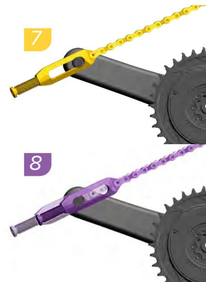
7. Coloque el cuerpo de la herramienta en el espárrago por la parte delantera de la herramienta.
