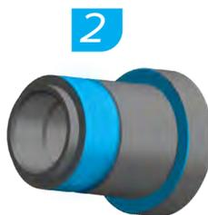
2. Aplique grasa a las roscas del perno de soporte y a la parte inferior de la brida del perno.
