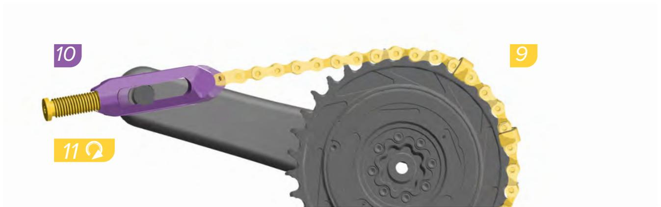
9. Enrolle la cadena de la herramienta, con los clips de plástico instalados, alrededor del plato de forma que la cadena quede engranada en los dientes.
