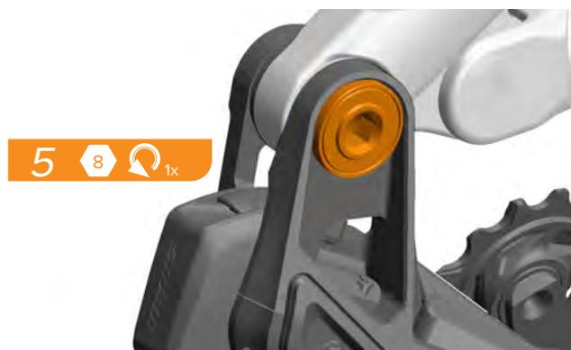
5. Afloje el perno del soporte una vuelta completa en sentido antihorario.
