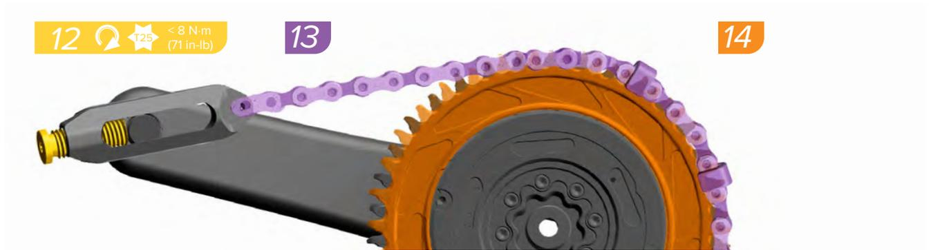
Coloque el juego de bielas sobre una superficie plana. Apriete el tornillo de la herramienta hasta que el plato se suelte. Es posible que oiga un chasquido; es normal. Si llega al final del tornillo y el plato no se afloja, libere la tensión, vuelva a instalar la cadena y repita el paso anterior.
