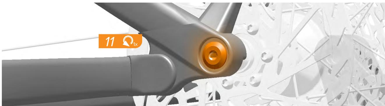
11. Afloje el perno del eje pasante una vuelta completa en sentido antihorario.
