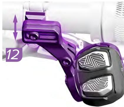
12. Mueva el puente verticalmente hasta la posición deseada.
