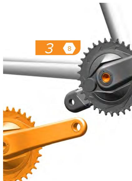
3. Extraiga el juego de bielas del lado motriz de la bicicleta. *El eje del lado no motriz puede dejarse instalado, si se desea.*
