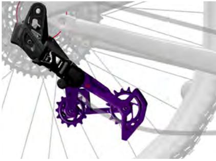
**Modo abierto:** La jaula del desviador está completamente extendida para el desmontaje e instalación de la rueda trasera.
