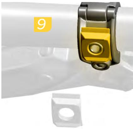
9. Instale la arandela ranurada en la abrazadera.
