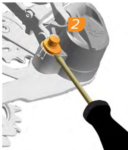
2. Utilice un destornillador pequeño de punta plana para extraer la llave de ajuste del desviador.
