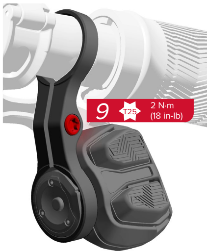
9. Tighten the clamp bolt.
