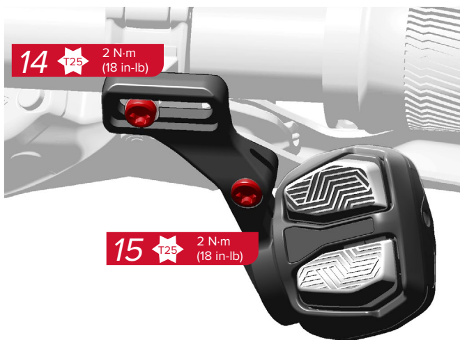
14. Tighten the bridge bolt.
