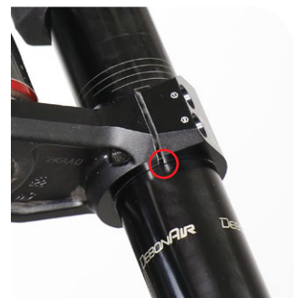
Incorrecto: fuera de la marca inferior de la corona
