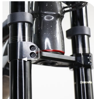
Posición de la marca de altura de la corona/
