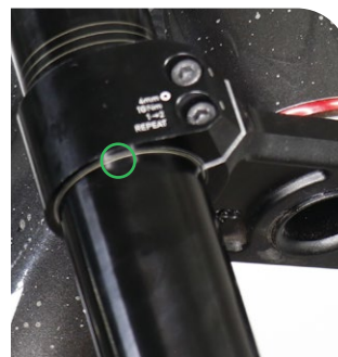
Correcto: dentro de la marca inferior de la corona
