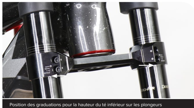
Position des graduations pour la hauteur du té inférieur sur les plongeurs
