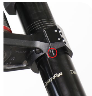
Incorrect - ne respecte pas les graduations du té inférieur
