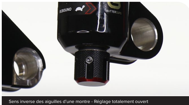
Sens inverse des aiguilles d'une montre - Réglage totalement ouvert
