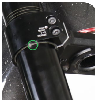
Correct - respecte les graduations du té inférieur
