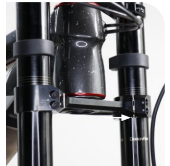
Position des graduations pour la hauteur des tés/plongeurs - Côté ressort
