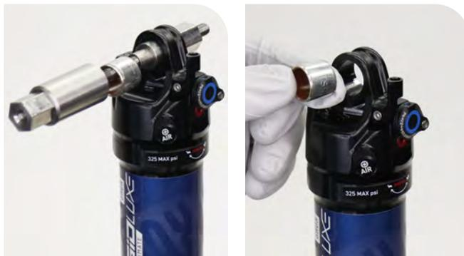
Para sustituir los casquillos de los ojales y las piezas de montaje, vaya a [Conjunto de ojal del amortiguador](#).
