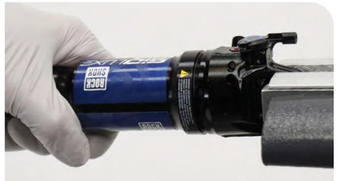
**5** Retire el amortiguador del tornillo de banco. Dele la vuelta y sujete el ojal del cuerpo del amortiguador en el tornillo de banco.
