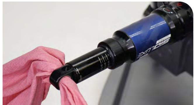
**10** Utilice una llave de correa para desmontar la lata de aire. Coloque la cinta en torno a la sección de la lata de aire más alejada del ojal del eje. Gire la llave en sentido antihorario para desenroscar la lata de aire.
