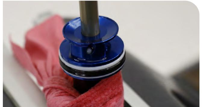
**6** Enrosque el tornillo de purgado en el orificio correspondiente hasta que note que entra en contacto con la bola de compresión; a continuación, apriete el tornillo de purgado otra media vuelta.
