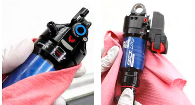
**7** Instale la junta tórica del indicador de hundimiento.
