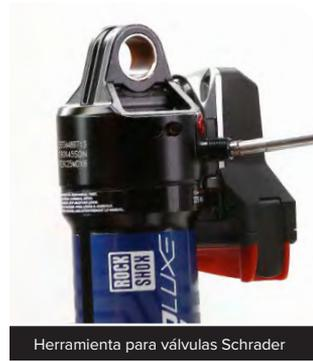
Herramienta para válvulas Schrader
