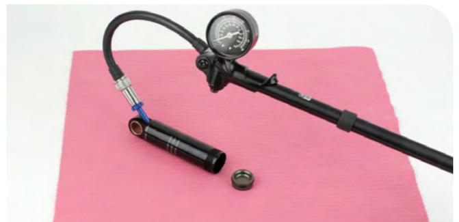
Herramienta adaptadora de válvula de aire RockShox SIDLuxe y bomba para amortiguadores
