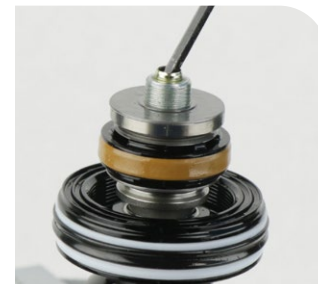
Conjunto del pistón instalado
