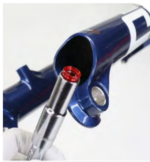
Ultimate/Select + : côté de la cartouche d'amortissement - 10 mm
