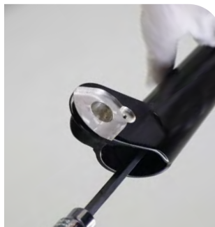
Select/Base : côté de la cartouche d'amortissement - 5 mm et maillet
