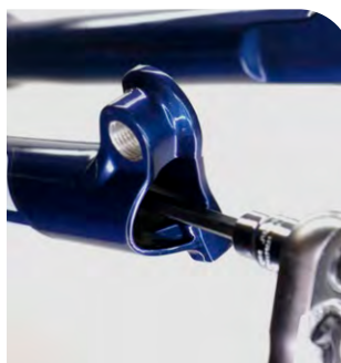
Ultimate/Select+ : côté ressort uniquement - 5 mm
