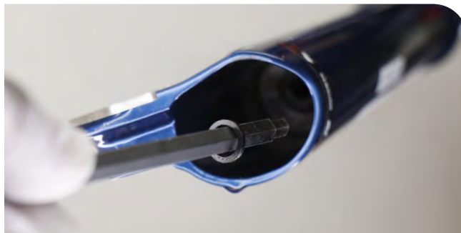
Ultimate/Select + : côté de la cartouche d'amortissement - 5 mm
