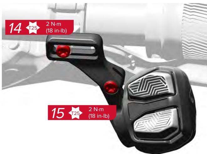
14. Ziehen Sie die Auslegerschraube fest.
