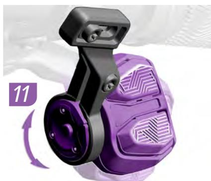
11. Faites pivoter l'unité de commande pour obtenir l'angle d'inclinaison souhaité.
