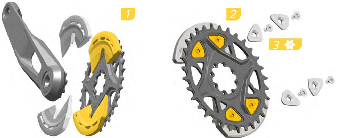
1. Installez la protection sur le devant du plateau, entre la manivelle et le plateau.
