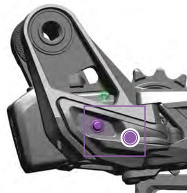
Sinon, appuyez une fois sur le bouton AXS du dérailleur pour déplacer le dérailleur vers l'extérieur d'un cran à la fois jusqu'à ce qu'il se trouve sur la plus petite vitesse (celle la plus à l'extérieur).
