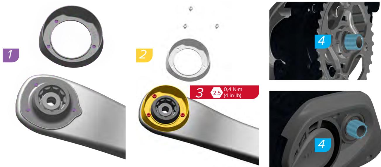
1. Alignez le capuchon d'intégration avec les orifices des vis situés sur la manivelle de droite.
