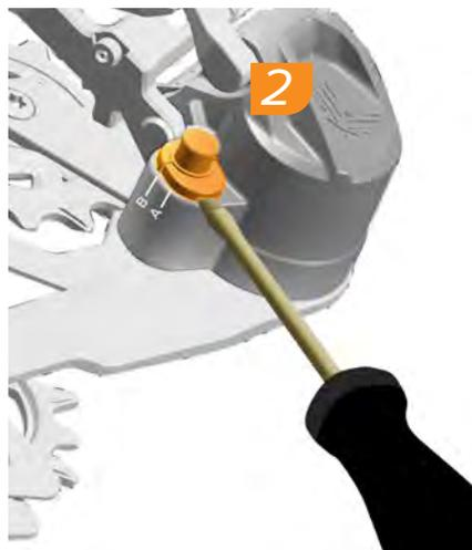
2. À l'aide d'un petit tournevis à tête plate, retirez la Clé de réglage du dérailleur.
