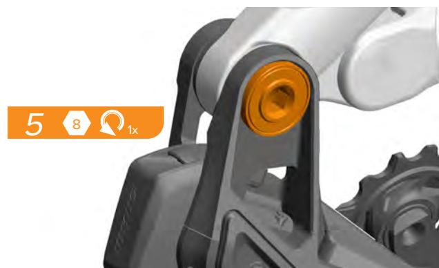
5. Desserrez la vis de fixation d'un tour complet dans le sens inverse des aiguilles d'une montre.
