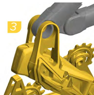
3. Installez le dérailleur Transmission en faisant coulisser la fixation complète par-dessus l'interface sans patte et l'insert du cadre pour bague.
