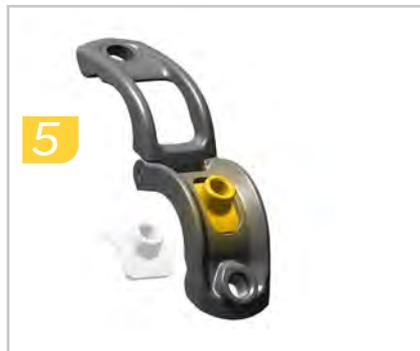
5. Installez l'écrou en T dans le collier.
