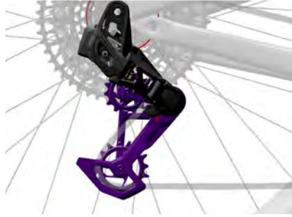
**Mode Réglage :** la chape du dérailleur est en position d'extension partielle pour aligner la chape avec l'un des deux repères de clé.
