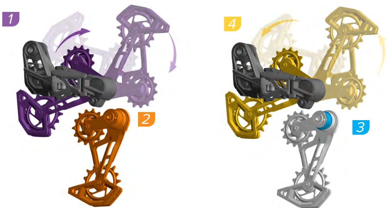
1. Maintenez le corps du dérailleur et faites pivoter la chape dans le sens des aiguilles d'une montre jusqu'à ce qu'elle se libère de l'articulation P.
