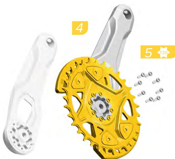
4. Installez le plateau avec sa protection sur la manivelle située du côté de la chaîne.
