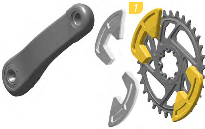
1. Installez la protection sur le devant du plateau, entre la manivelle et le plateau, à travers la partie ajourée du plateau.
