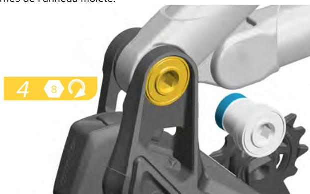
4. Installez la vis de fixation et serrez-la dans le sens des aiguilles d'une montre.
