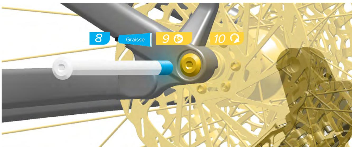
8. Appliquez de la graisse sur le filetage de l'axe traversant avant d'installer l'axe.
