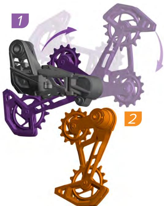
1. Maintenez le corps du dérailleur et faites pivoter la chape dans le sens des aiguilles d'une montre jusqu'à ce qu'elle se libère de l'articulation P.
