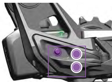
Sinon, appuyez rapidement à deux reprises sur le bouton AXS du dérailleur pour déplacer le dérailleur vers l'intérieur d'un cran à la fois jusqu'à ce qu'il se trouve sur la position du Pignon de réglage.
