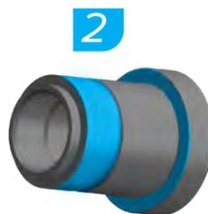
2. Appliquez de la graisse sur le filetage de la vis de fixation et sur le dessous du flasque de la vis.
