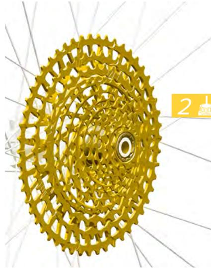
2. Installez la cassette sur le corps de cassette en veillant à bien engager les cannelures. Pour serrer la cassette, utilisez un outil doté d'une broche de guidage tout en appuyant sur la cassette vers l'intérieur.
