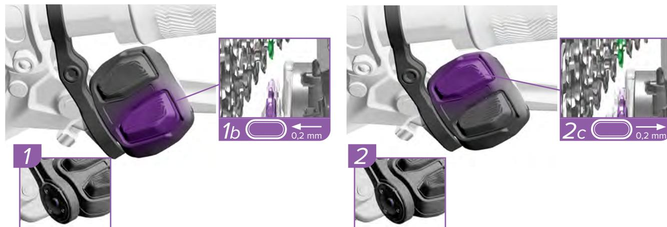
Optimisez les performances de votre dérailleur et éliminez les bruits parasites en affinant le réglage de la position du dérailleur grâce à la fonction MicroAdjust. La fonction MicroAdjust permet de régler sa position sur l'ensemble des pignons de la cassette. Il n'y a pas de réglage spécifique à chaque pignon.
