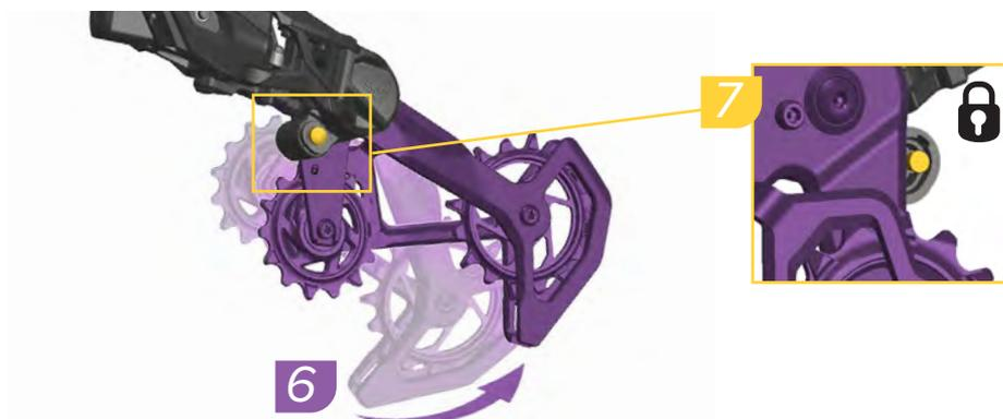
6. Faites pivoter la chape du dérailleur vers l'avant jusqu'à ce que l'icône du verrou marqué sur la chape libère la Clé de réglage.
