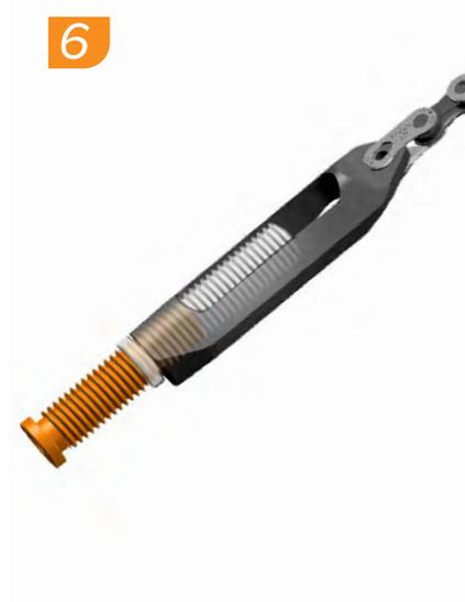
6. Desserrez la vis du corps de l'outil jusqu'à ce qu'elle ne soit plus visible dans la fente. Ne retirez pas complètement la vis.
