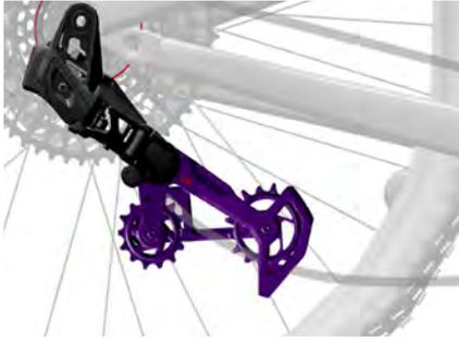
**Mode Ouvert :** la chape du dérailleur est en position d'extension complète pour permettre l'installation ou le démontage de la roue arrière.
