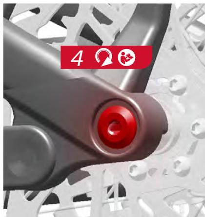
4. Serrez l'axe arrière au couple recommandé en fonction des instructions du fabricant du cadre ou de l'axe.
