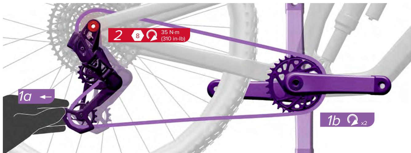
1a. Tirez la chape inférieure du dérailleur Transmission vers l'arrière pour tendre la chaîne.
