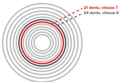
12. Positionnez la chaîne Eagle T-Type préalablement coupée à la bonne longueur sur le pignon de réglage de 21 ou 24 dents, puis faites-la passer à travers les galets du dérailleur avec le côté plat de la chaîne tourné vers l'extérieur de la cassette. Vérifiez que la chaîne passe bien sous la languette de la chape.
