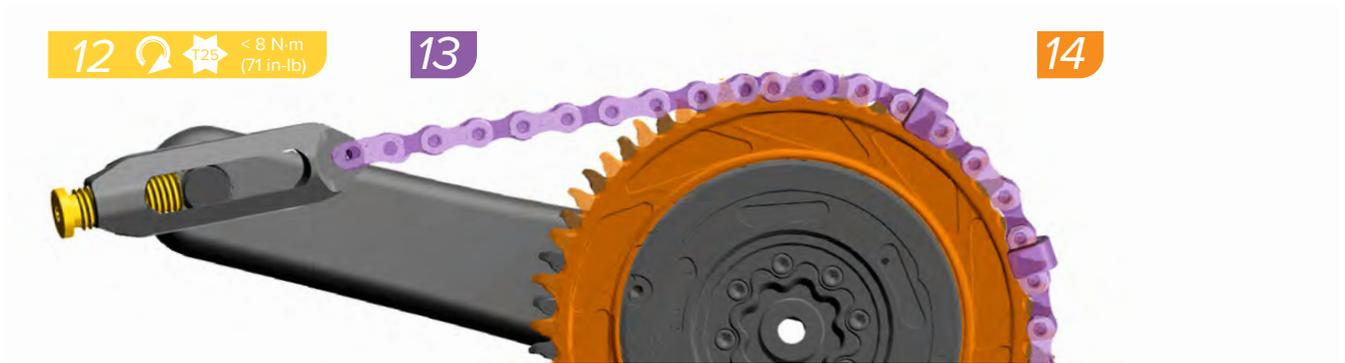
Déposez le pédalier sur une surface plane. Serrez la vis de l'outil jusqu'à ce que le plateau se libère. Vous pourrez peut-être entendre un claquement : ceci est normal. Si vous atteignez l'extrémité de la vis et que le plateau n'est pas desserré, relâchez la tension, remettez la chaîne en place et reprenez l'étape précédente.
