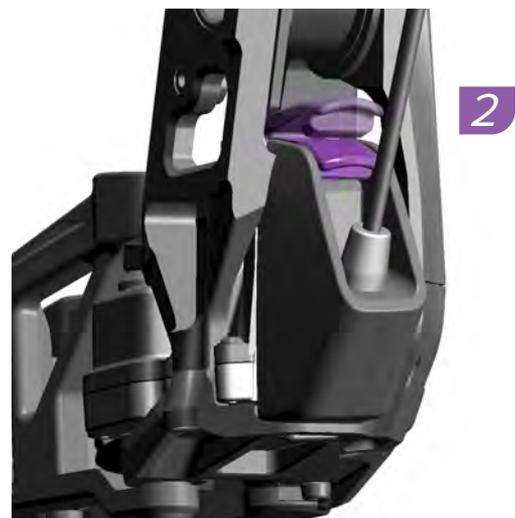
2. Fermez le loquet de la batterie. Si l'installation est correcte, le loquet s'enclenchera avec un petit déclic.
