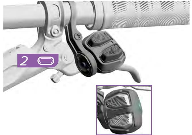
Pour les configurations utilisant deux unités de commande AXS, synchronisez d'abord l'unité de commande de droite.
