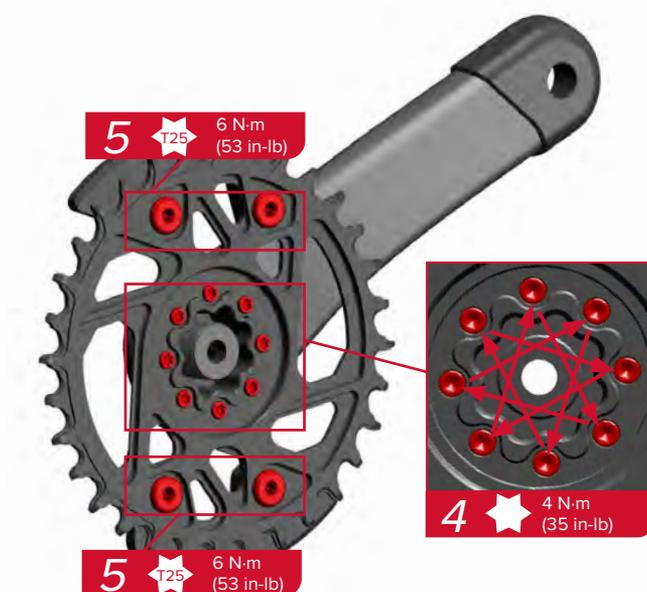
4. Serrez les vis de fixation d'un tour, en alternance selon un schéma en croix, jusqu'à obtenir un couple de serrage de 4 N-m pour chaque vis.
