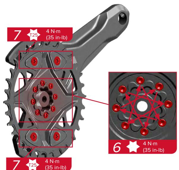
6. Serrez les vis de fixation d'un tour, en alternance selon un schéma en croix, jusqu'à obtenir un couple de serrage de 4 N-m pour chaque vis.
