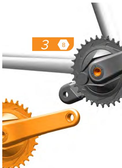
3. Retirez la partie du pédalier située du côté de la chaîne. *L'axe du côté opposé à la chaîne peut rester en place si nécessaire.*
