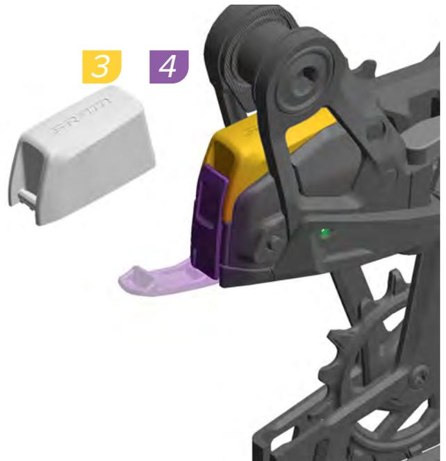
3. Insérez la batterie SRAM entièrement chargée dans le dérailleur.
