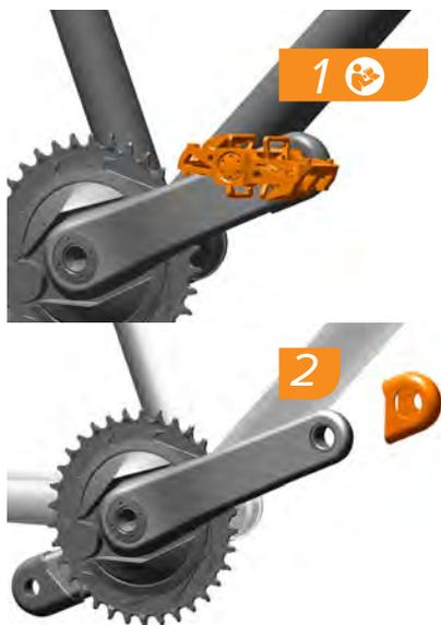
1. Tout en laissant le pédalier installé sur le vélo, retirez la manivelle située du côté de la chaîne.
