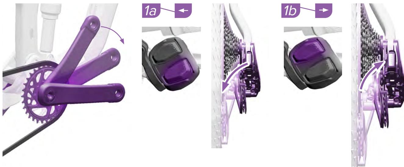
1a. Tournez lentement le pédalier et appuyez sur le bouton inférieur de l'unité de commande AXS Pod pour déplacer le dérailleur à fond vers l'intérieur.
