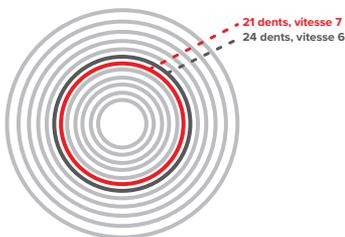
Consultez le site Web AXS à l'adresse [www.sram.com](http://www.sram.com) ou utilisez l'app SRAM AXS pour déterminer la taille en 21 ou 24 dents du **Pignon de réglage**. Le pignon de 21 dents est la vitesse 7 ; il est schématisé sur la cassette par un cercle rouge. Le pignon de 24 dents est la vitesse 6 ; c'est le pignon qui suit immédiatement par ordre de taille.
