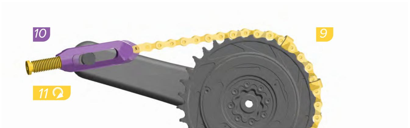
9. Enroulez la chaîne de l'outil munie des clips en plastique autour du plateau de sorte que la chaîne s'engage sur les dents du plateau.
