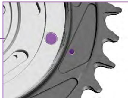
2. Placez le nouveau plateau sur le côté interne de l'étoile capteur de puissance de sorte que les points blancs marqués sur l'étoile et le plateau soient alignés.
